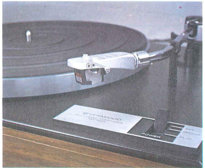
Il piatto Kenwood utilizza un sistema di antiskating a gravità, non molto pratico, ma notevolmente preciso se ben realizzato. La testina in dotazione è il modello N 38 MK II, di produzione della stessa Kenwood.
