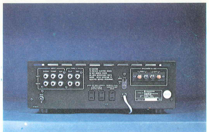
L'amplificatore KA 1500 è un apparecchio di pregio, con una notevole riserva di potenza (abbiamo misurato 35+35 W RMS) ed una buona versatilità. Il controllo di volume è a scatti, con una grossa manopola al centro del pannello frontale; utile la duplicazione (DIN) dell'ingresso «TAPE» sul pannello frontale (in basso a destra). Le morsettiere posteriori per gli altoparlanti sono a vite con manopola zigrinata, azionabili anche a mano con facilità. Tre le prese di rete per l'alimentazione di apparecchiature ausiliarie, due delle quali asservite all'interruttore di accensione.
