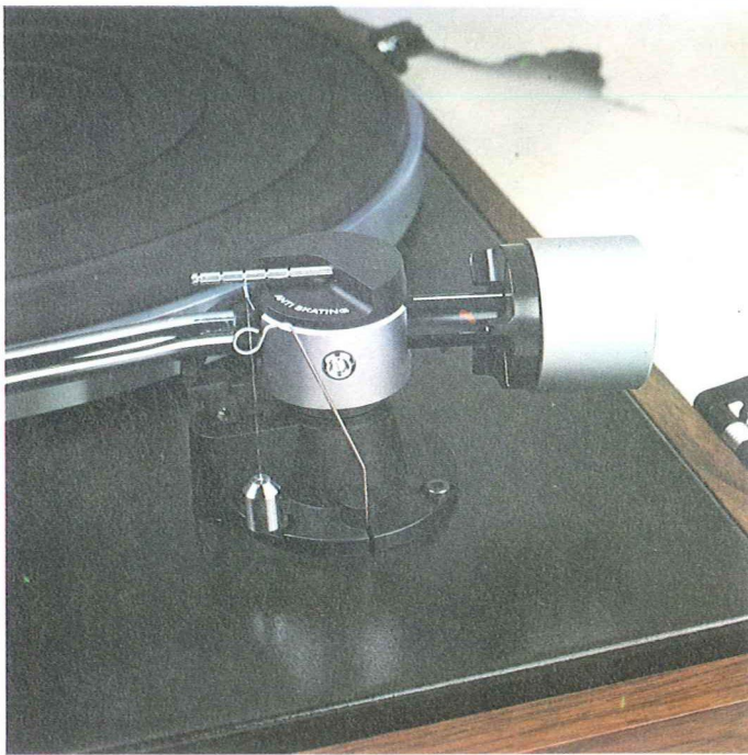
Il piatto Kenwood utilizza un sistema di antiskating a gravità, non molto pratico, ma notevolmente preciso se ben realizzato. La testina in dotazione è il modello N 38 MK II, di produzione della stessa Kenwood.
