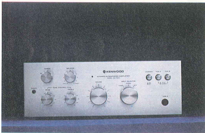
L'amplificatore KA 1500 è un apparecchio di pregio, con una notevole riserva di potenza (abbiamo misurato 35+35 W RMS) ed una buona versatilità. Il controllo di volume è a scatti, con una grossa manopola al centro del pannello frontale; utile la duplicazione (DIN) dell'ingresso «TAPE» sul pannello frontale (in basso a destra). Le morsettiere posteriori per gli altoparlanti sono a vite con manopola zigrinata, azionabili anche a mano con facilità. Tre le prese di rete per l'alimentazione di apparecchiature ausiliarie, due delle quali asservite all'interruttore di accensione.
